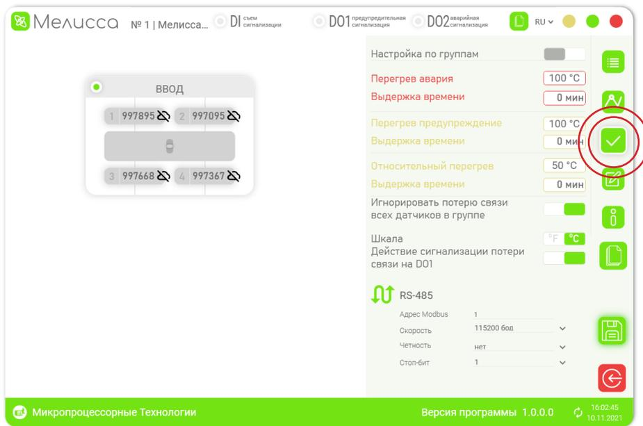
7. Задайте установки по температуре и задержки срабатывания.
