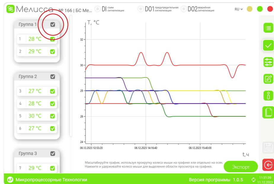
Архив измерений выгружается в файл формата \*.csv. В нём указывается метка времени и температура датчика за период.
