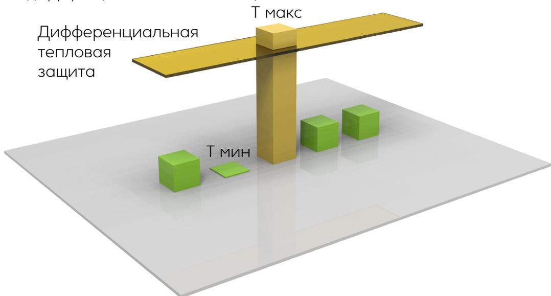
Алгоритм позволяет определить нагревание какого-либо датчика на фоне других, объединенных с ним в группу. При превышении разницей температур самой нагретой и самой холодной точек контроля в группе уставки «**Дифференциальная тепловая защита**», с выдержкой времени формируется триггерный выходной сигнал «**Группа n – Дифференциальная тепловая защита**», вызывающий предупредительную сигнализацию.
