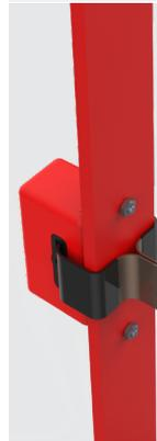
4) Прижать концы ленты друг к другу, обеспечив плотное прилегание к шине/кабелю. Надеть зажим и зафиксировать его, используя винт, шайбу и гровер. Зафиксировать ленту так, чтобы ее концы были заподлицо с зажимом.
