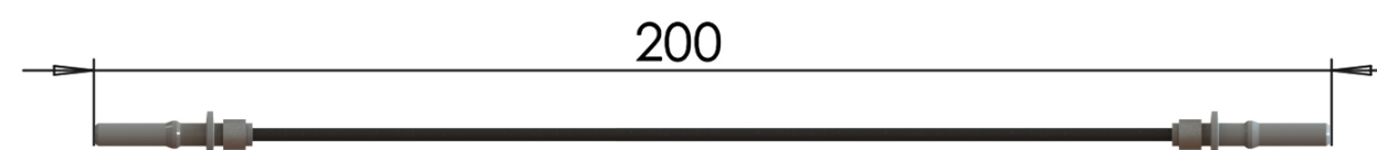
Рисунок 1.7 – Внешний вид и габаритные размеры оптической перемычки
