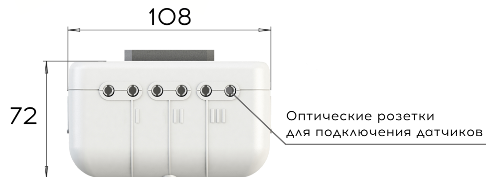
Рисунок 1.13 - Вид сверху и назначение оптических розеток
