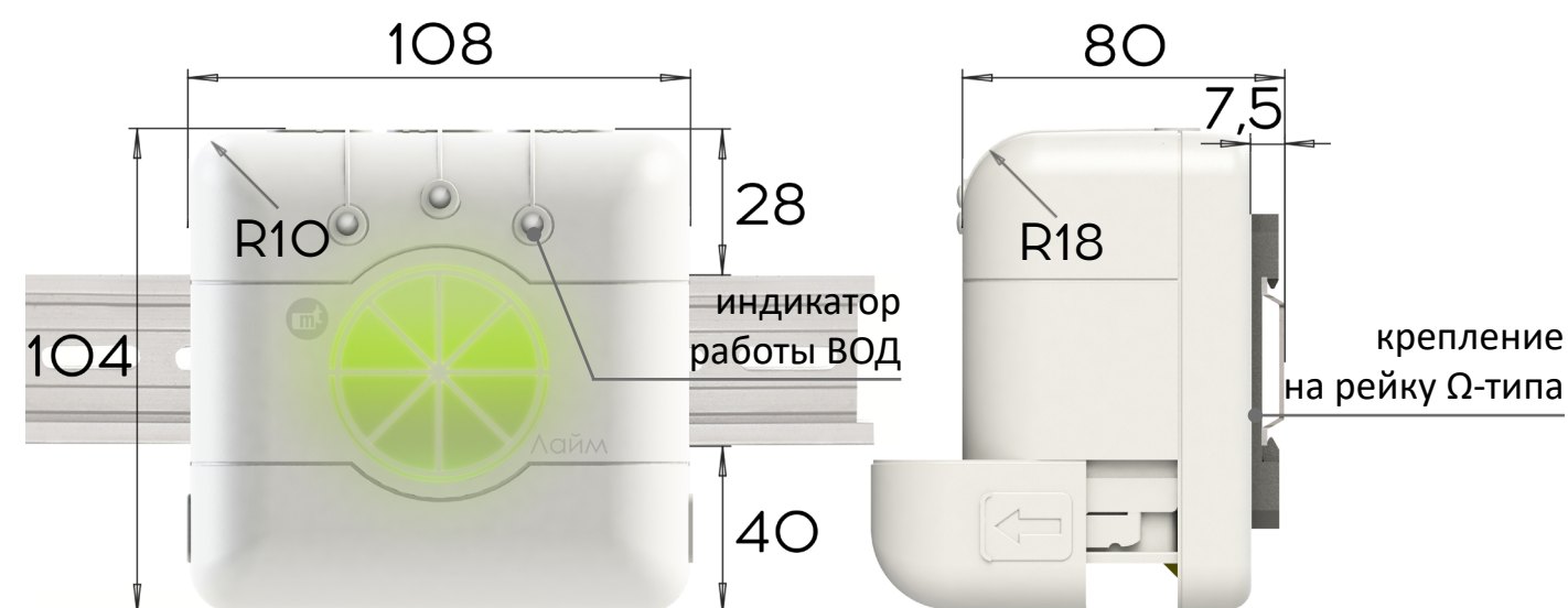
Рисунок 1.5 - Внешний вид и габаритные размеры Лайм
