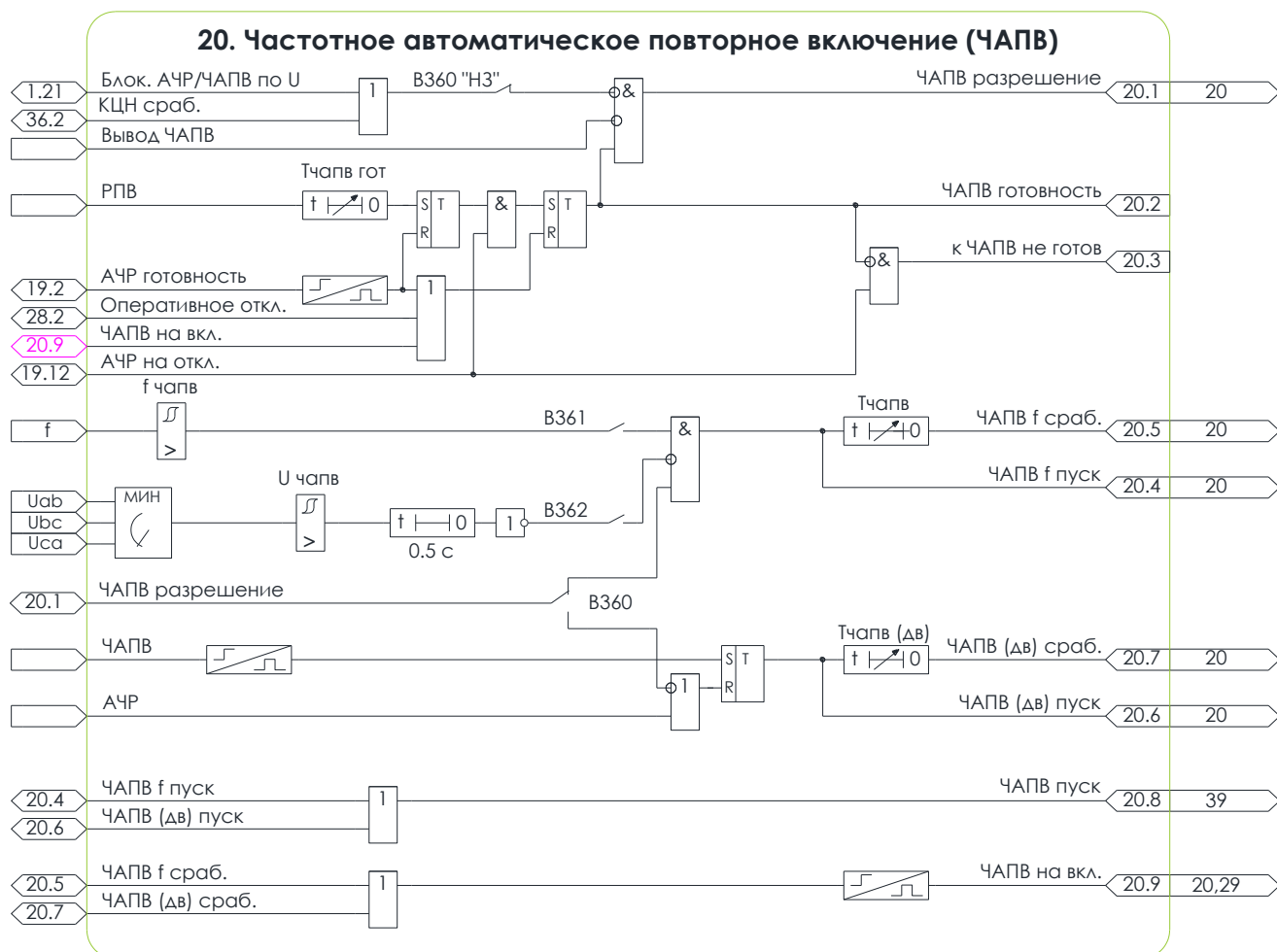
Рисунок 5.19 – Схема №20. Алгоритм ЧАПВ
