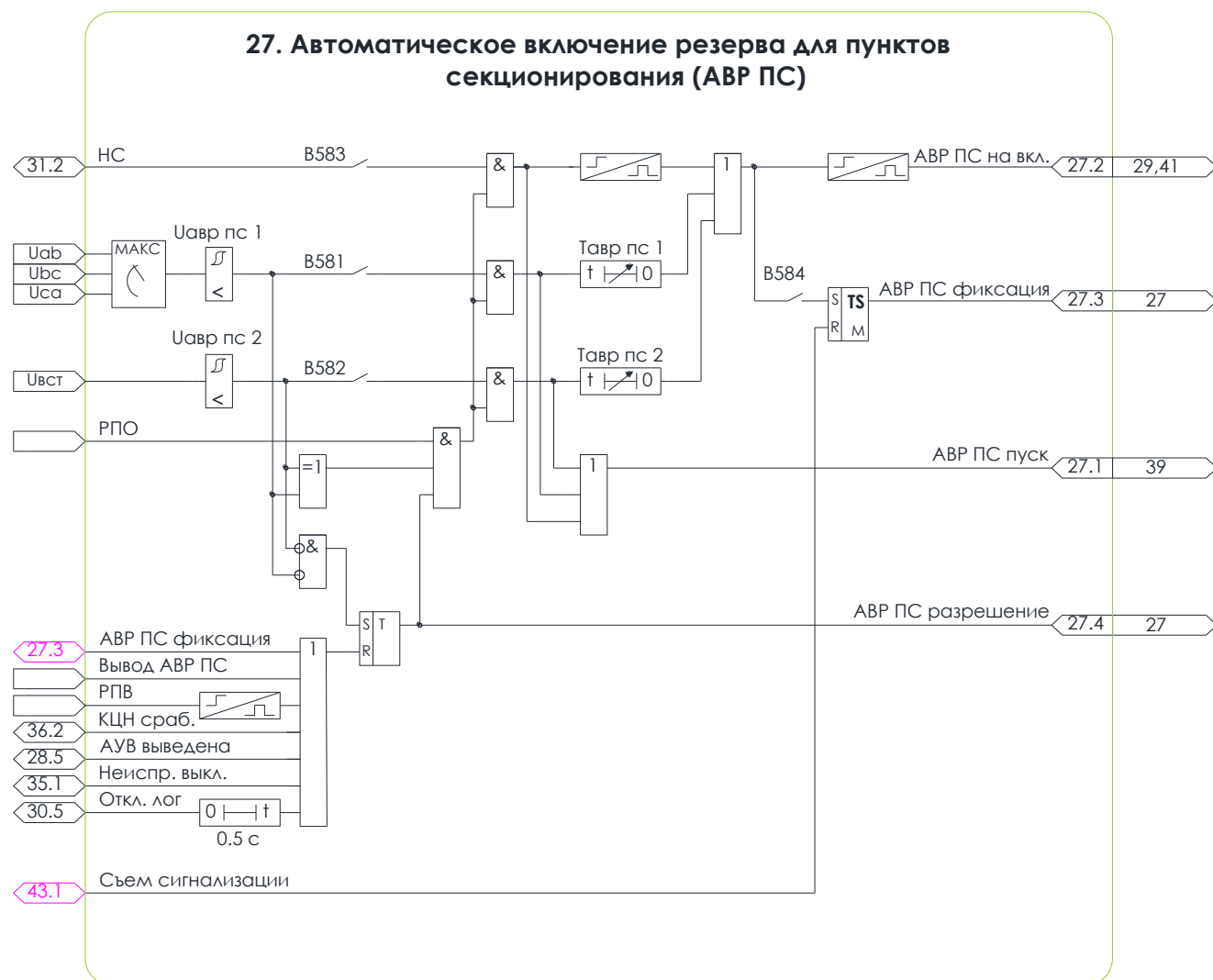
Рисунок 5.25 – Схема №25. Алгоритм АВР ПС
