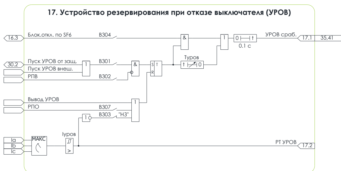
Рисунок 5.17 – Схема №17. Алгоритм УРОВ
