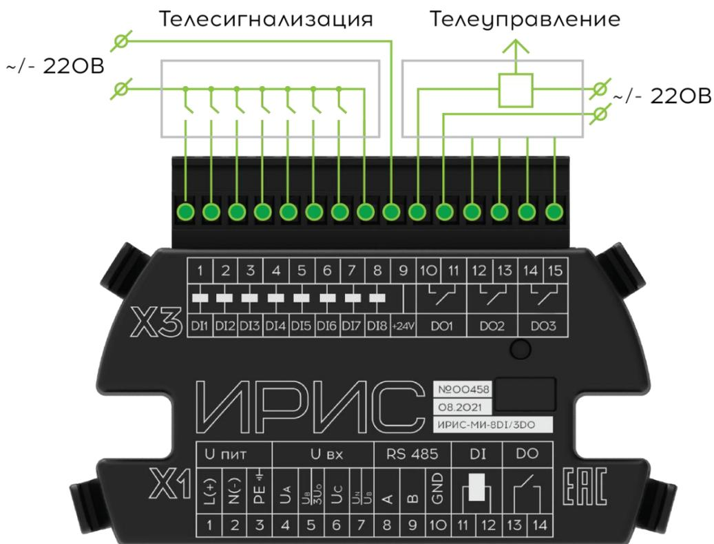
Рисунок 12.8 - Схема подключения рюкзача ИРИС - 8DI/3DO-220V
