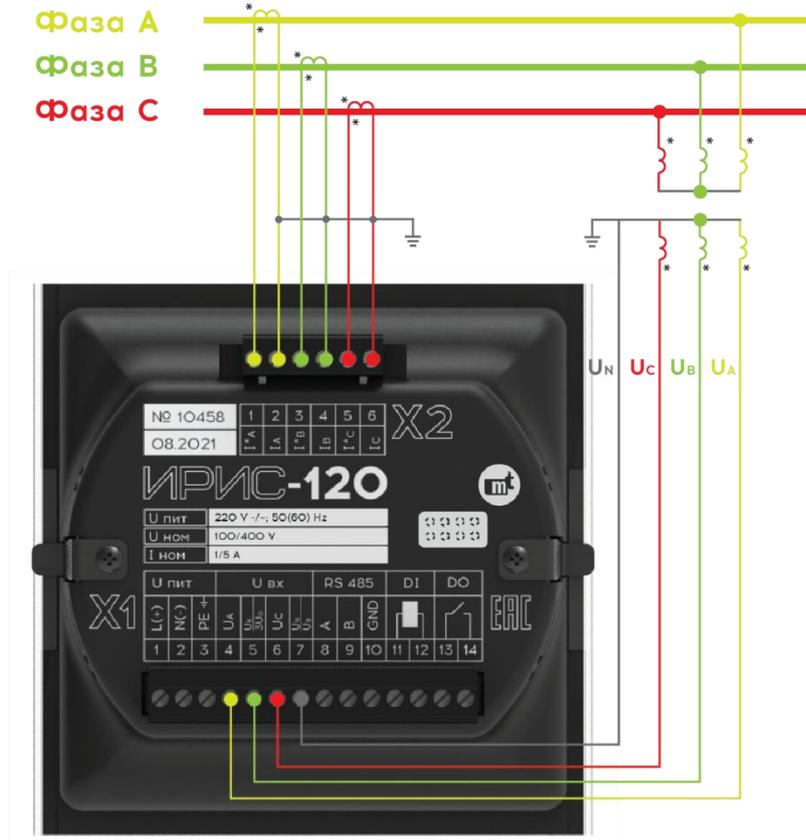
Рисунок 10.2 - Схема подключения устройства с внешними трансформаторами тока и трансформаторами напряжения (ЗТ, ЗТН)
