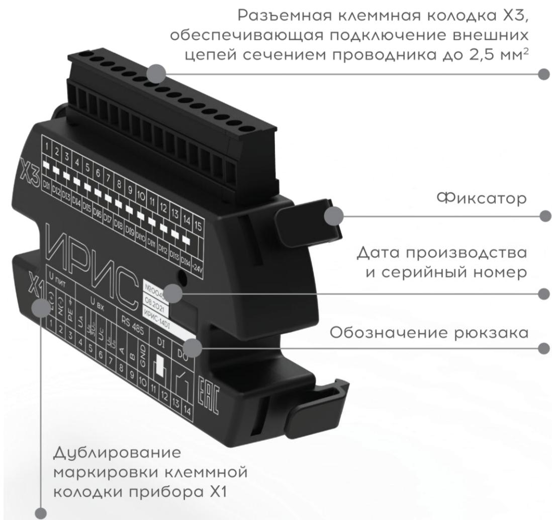
Рисунок 12.2 – Внешний вид модуля расширения
