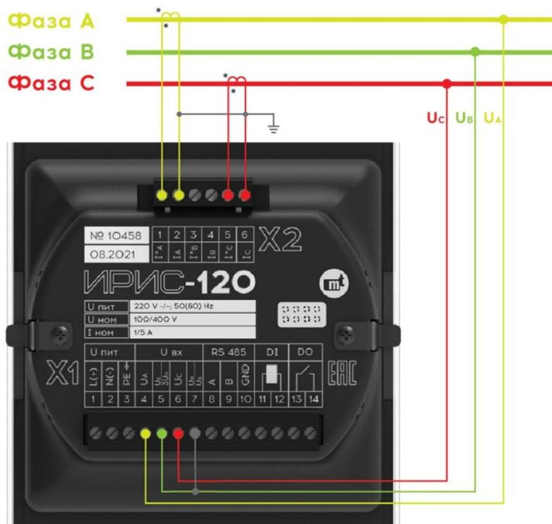
Рисунок 10.4 - Схема подключения устройства с внешними трансформаторами тока, без трансформаторов напряжения (2ТТ, 0ТН)
