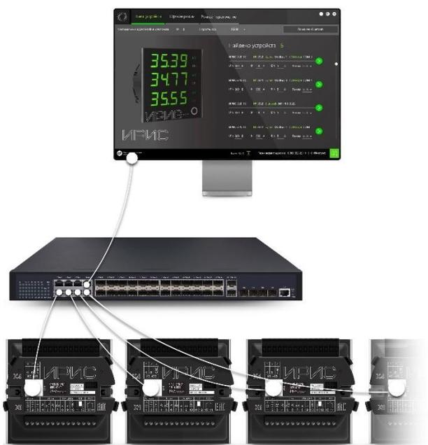
Рисунок 12.5– Схема организации сети Ethernet
