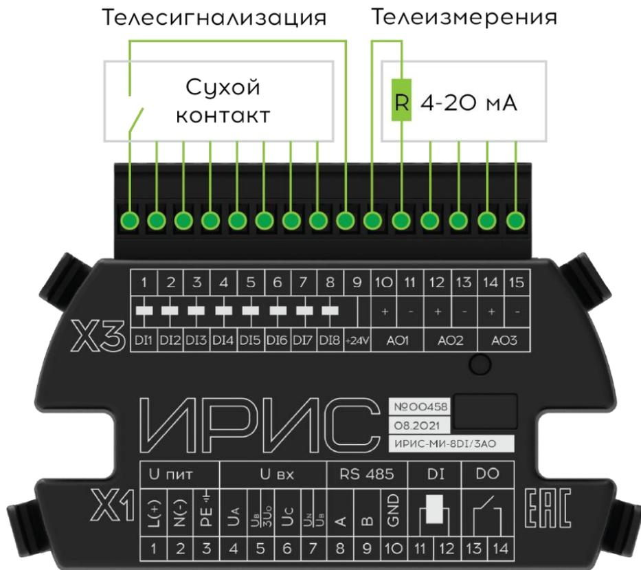
Рисунок 12.9 - Схема подключения рюкзак ИРИС - 8DI/3AO
