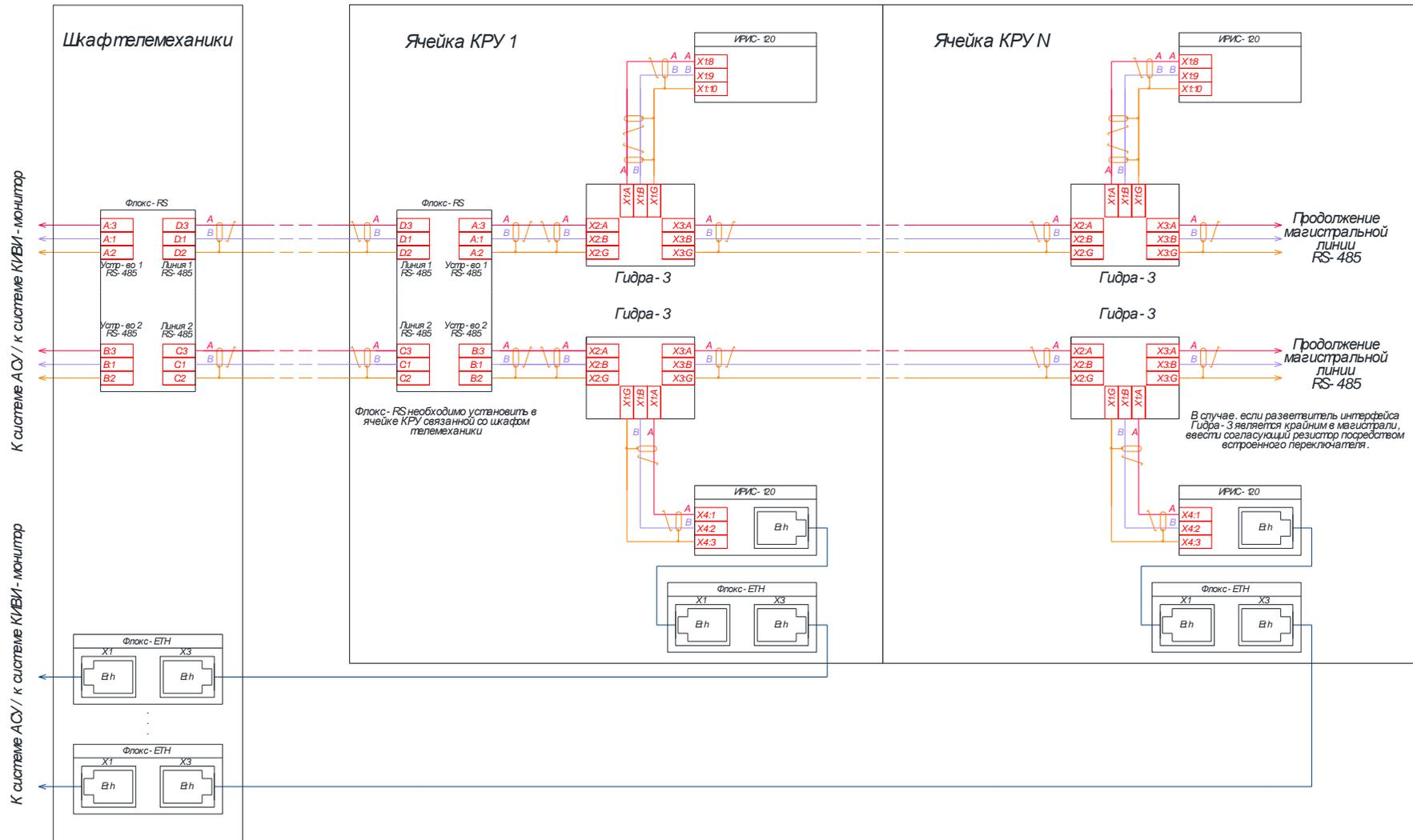
Рисунок 13.1 – Схема организации линий связи интерфейсов RS-485, Ethernet с применением устройств Гидра-3, Флокс-RS, Флокс-ETH
