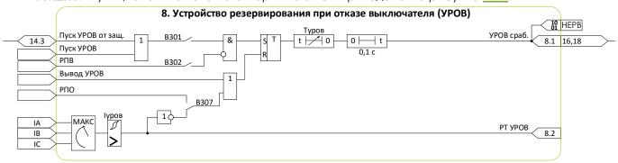
Рисунок 7.12 - Схема №8. Алгоритм УРОВ
