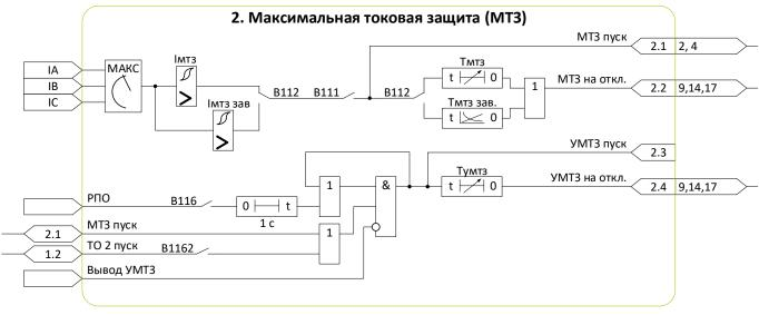
Рисунок 7.3 – Схема №2. Алгоритм МТЗ
