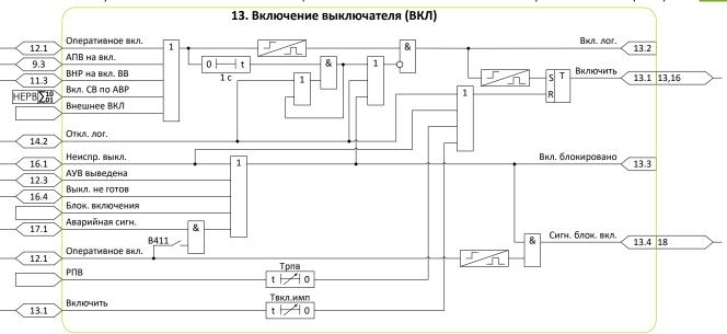
Рисунок 7.17 – Схема №13. Алгоритм включения выключателя
