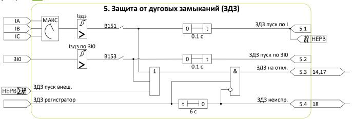
Рисунок 7.8 - Схема №5. Алгоритм 3Д3
