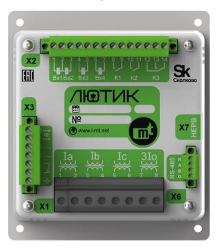
Рисунок 6.4 – Задняя панель устройства Лютик аппаратной версии 3.ХХ
