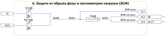
Рисунок 7.9 - Схема №6. Алгоритм ЗОФ
