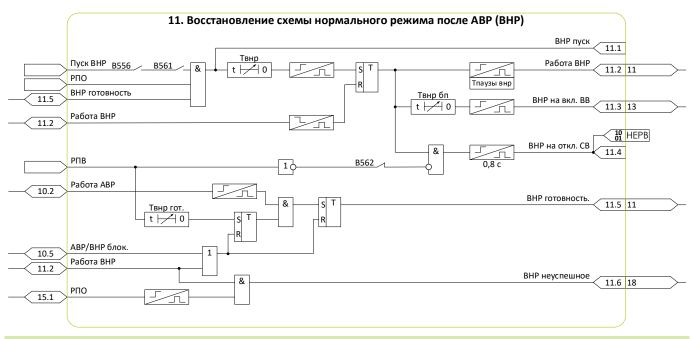
Рисунок 7.15 - Схема №11. Алгоритм ВНР
