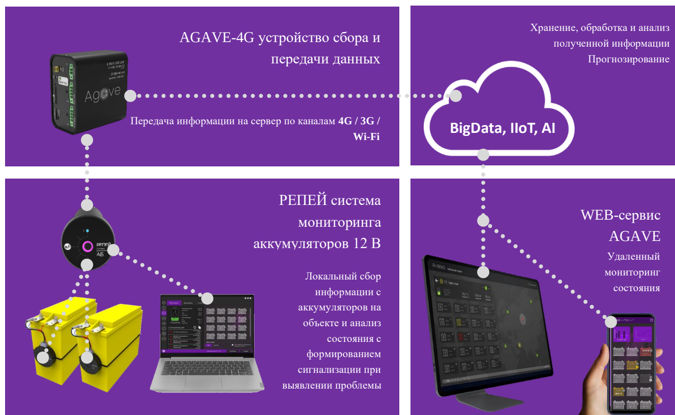
Рисунок 1.1 – структурная схема системы РЕПЕЙ
