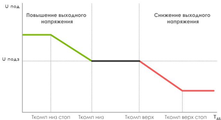
Рисунок 5.2 – Термокомпенсация напряжения при различных значениях «Ткомп низ» и «Ткомп верх»
