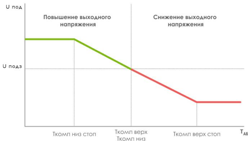
Рисунок 5.3 – Термокомпенсация напряжения при одинаковых значениях «Ткомп низ» и «Ткомп верх».
