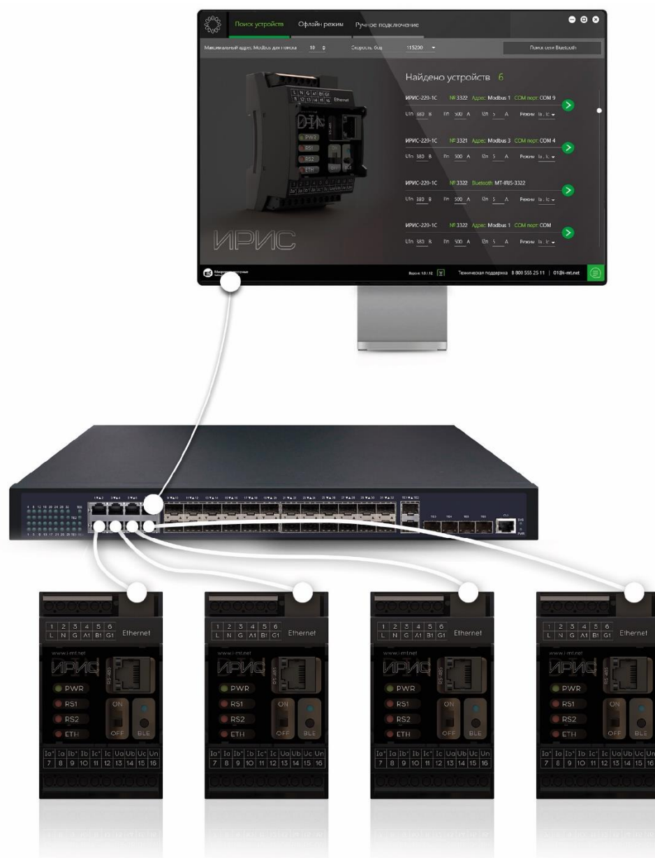
Рисунок 4.4 – Схема организации сети Ethernet
