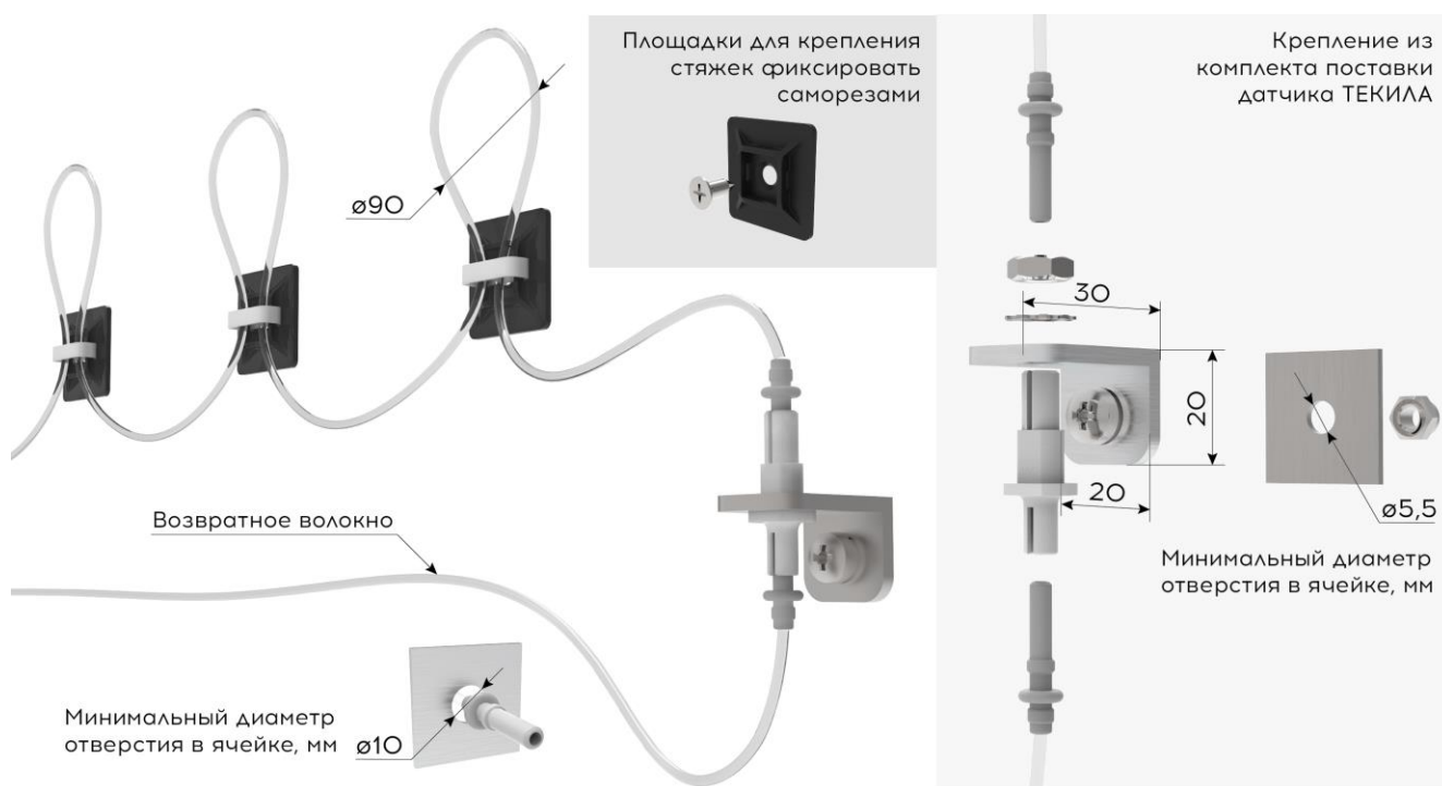
Рисунок 6.2 – монтаж петлевого датчика ТЕКИЛА
