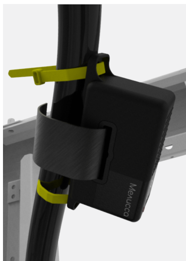
Вариант 2: крепление хомутом Питание датчика осуществляется от электромагнитного поля контролируемого присоединения через ленту-сердечник.
