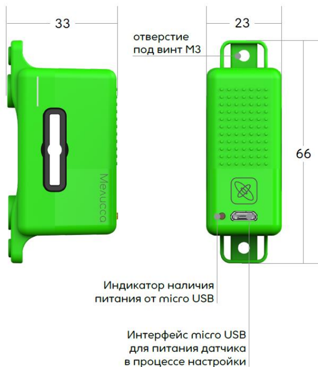
Рисунок 3.2 Внешний вид и габариты температурного датчика
